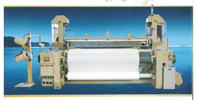
该机型具有坚韧的由两侧箱式机架、方管、槽钢结构横梁与中间付墙板构成了稳定可靠的整体化结构,振动小、噪音低,对细支高密织物的织造,在同类机型中首屈一指,拉伸喷嘴、第一纬延迟、自动寻纬等标准功能可有效提高开机效率。
